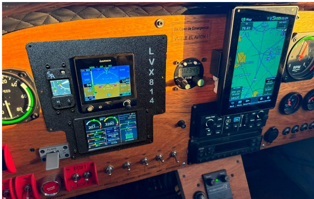
Ilustración 3 - Módulo TrimFlap instalado en Tablero
