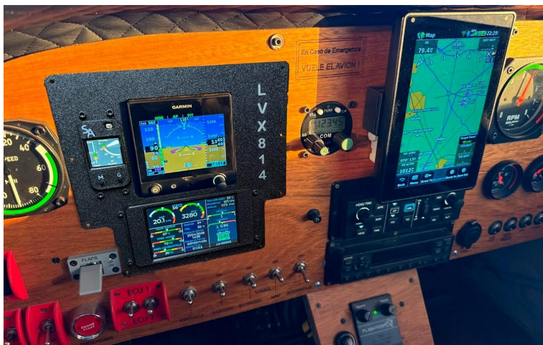
Ilustración 3 - Módulo TrimFlap instalado en Tablero
